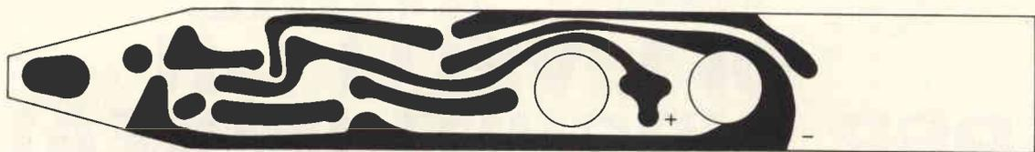
Fig. 3 - Circuito stampato dell'indicatore L-H, visto dal lato rame, secondo lo schema di figura 1.
